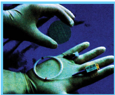
Σχήμα 4.4.9 Συσκευασμένο laser ημιαγωγού με προσαρτημένη την οπτική ίνα. Φαίνεται επίσης το ημιαγωγικό δισκίο από το οποίο προήλθε το laser.
