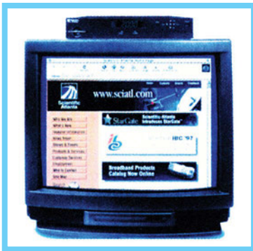
Σχήμα 9.6.2 Στη φωτογραφία φαίνεται η συσκευή STB τοποθετημένη πάνω στον τηλεοπτικό δέκτη. Η συσκευή STB μπορεί να χαρακτηριστεί «υβριδική», εφόσον περιέχει έναν υπολογιστή και ένα μόντεμ. Δίνει τη δυνατότητα «πλοήγησης» στο διαδίκτυο με ένα τηλεχειριστήριο. Μπορεί επίσης να συνδεθεί και με όλες τις οικιακές ηλεκτρονικές συσκευές εικόνας και ήχου. Για παράδειγμα μπορεί να κατευθύνει τη μουσική από το διαδίκτυο στο στερεοφωνικό συγκρότημα ή την εικόνα από τη βιντεοκάμερα σε άλλον συνδρομητή.
